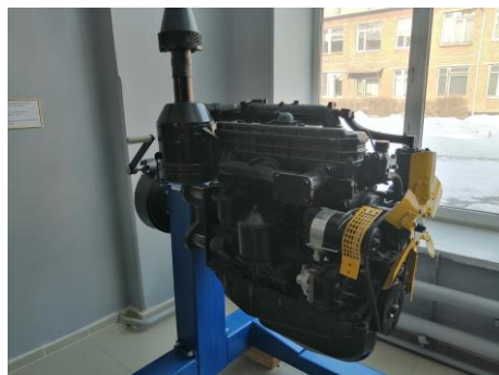
Стенд-тренажер по сборке-разборке дизельного двигателя трактора.
