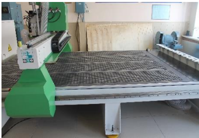
Трёхосевой фрезерный станок с ЧПУ промышленной серии
