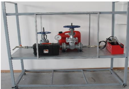
Испытательный стенд «Запорной арматуры»
