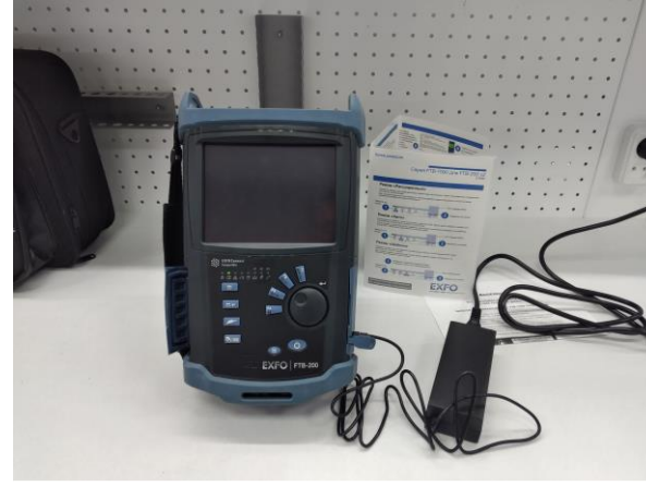
Платформа для поиска повреждений на трассе «FTB 200»
