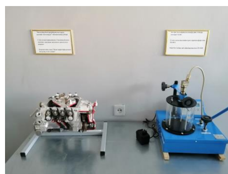
Стенд демонстрационный «Топливный насос высокого давления дизельного двигателя в разрезе. Стенд проверки форсунок»
