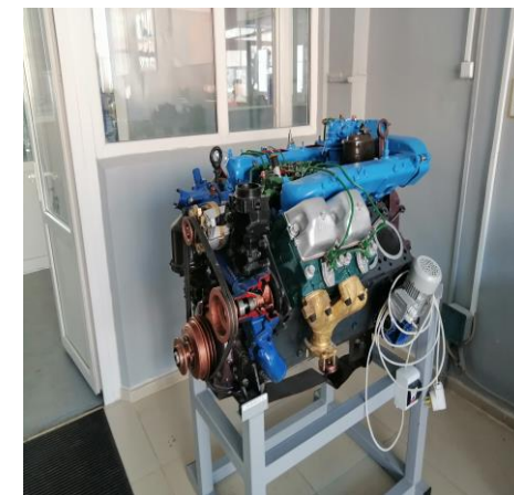
Двигатель грузового автомобиля (агрегаты в разрезе) с электромеханическим приводом
